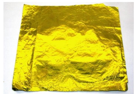
「人工衛星」外壁用耐熱フィルム（実物の一部）
